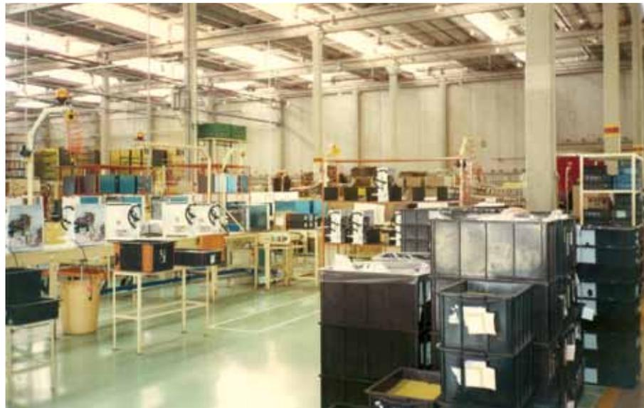
*Interior da fábrica de lavadoras e fogões da Whirlpool, com as caixas típicas do sistema Kanban.
